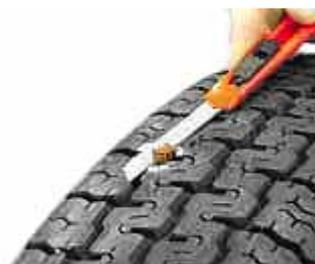
7. Cortar el excedente del obturador a ras del neumático. Inflar el neumático a la presión idónea.
