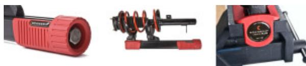
*El tensor de muelles de suspensión ha sido proyectado exclusivamente para tensar y destensar muelles cilíndricos y cónicos en columnas de suspensión McPherson, siendo imprescindible utilizar las placas de apriete adecuadas en cada caso. Toda aplicación diferente es considerada antirreglamentaria.*
