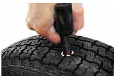
5. Insertar el punzón de aplicación, con un movimiento fino y profundo, evitando hacerlo girar de derecha a izquierda y viceversa.
