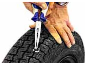
1. Extraer el objeto que ha ocasionado el pinchazo. Inflar el neumático a una presión de 1 bar.
