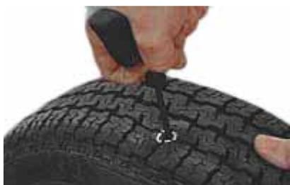
2. Introducir el punzón estriado por el orificio, impregnado de cemento vulcanizante.
