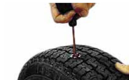
6. Extraer el punzón de aplicación, quedando parte del obturador dentro del neumático.
