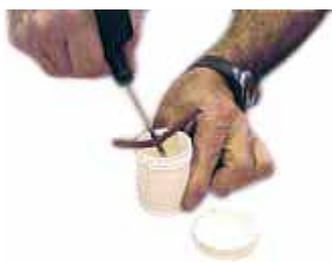
4. Introducir el obturador por la ranura del punzón de aplicación y aplicarle una capa de cemento vulcanizante.
